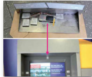
Handykamera in Blende zum Filmen der Tastatureingabe
