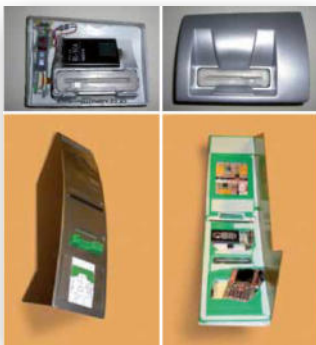
Manipulierter Karteneinschub mit Magnet- streifenleser
